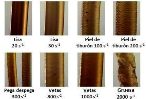
Figura 7. Fractura de fundido para el PELBD a diferentes velocidades de corte. [Tomada y modificada de (11)]
