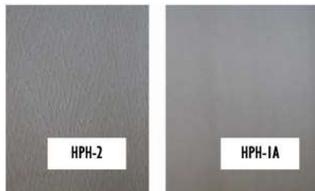
Figura 4. Ejemplos de películas con fractura de fundido extrema (HPH-2) y ausencia de fractura (HPH-1A).
