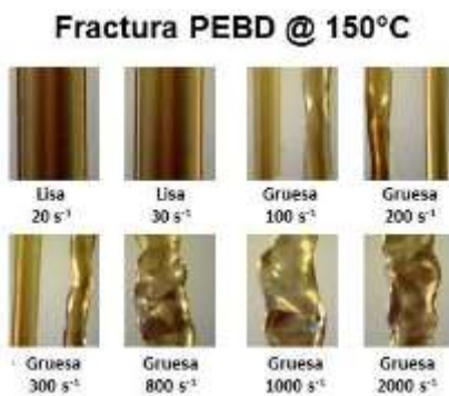
Figura 6. Fractura de fundido para el PEBD a diferentes velocidades de corte en un reómetro capilar. [Tomada y modificada de (11)]
