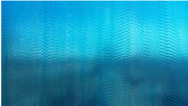
Figura 5. Fotografía de fractura de fundido de una película extruida de PELBD.
