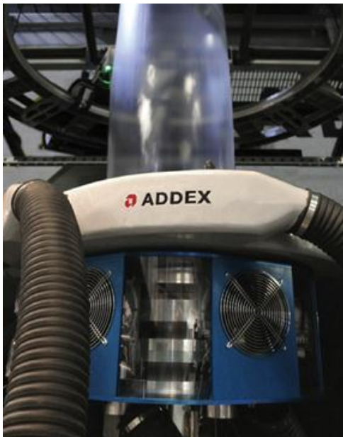
Figura 6. Sistema de enfriamiento ICE de Addex [tomado de la revista Film, Sheet and Extrusion, Noviembre 2016].
