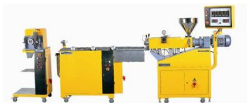
Figura 16. Línea de extrusión doble tornillo para la preparación de formulaciones de Lab Tech Engineering [Tomado de página web www.labtechengineering.com ]
