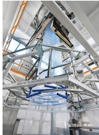
Figura 7. Co-extrusora de 5 capas TechnoFlex Plus de Bandera [tomado de la revista Film, Sheet and Extrusion, Noviembre 2016].
