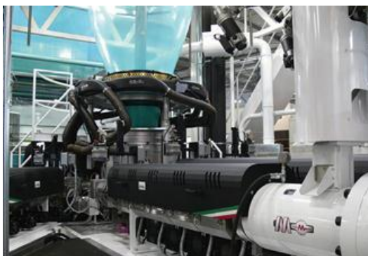
Figura 8. Línea POD de Macchi para producir bolsas de pie (stand up pouches) [tomado de Film & Sheet Extrusion magazine. Octubre 2016].
